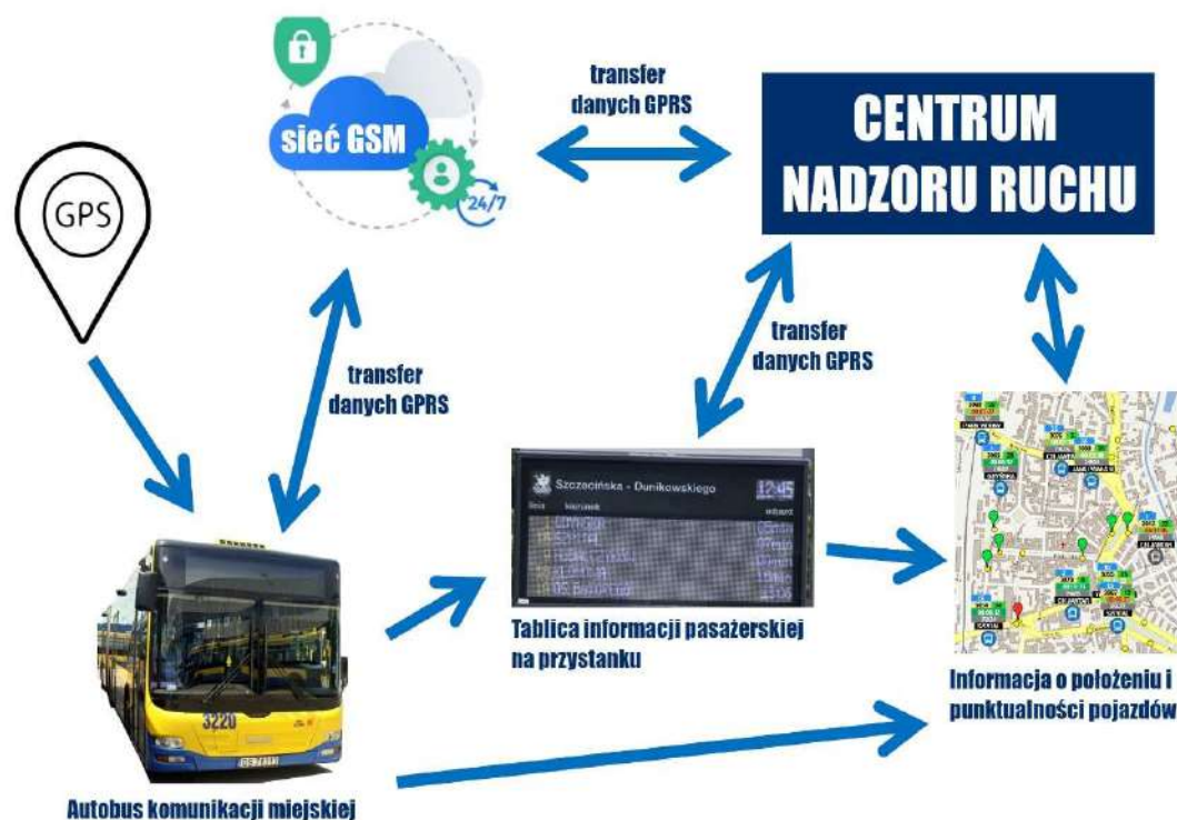
Grafika 1 Schemat systemu dynamicznej informacji pasażerskiej i nadzoru ruchu - ZIM Słupsk
